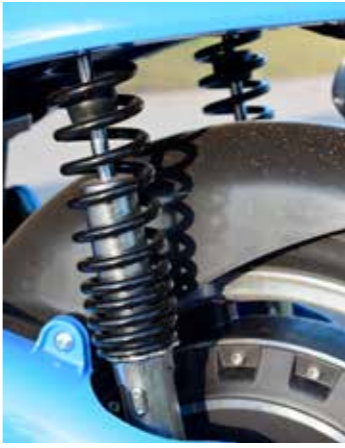
Dubbele telescopische achterveren
