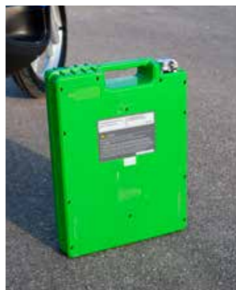
De 28Ah lithium accu weegt zo'n 10 kilo
